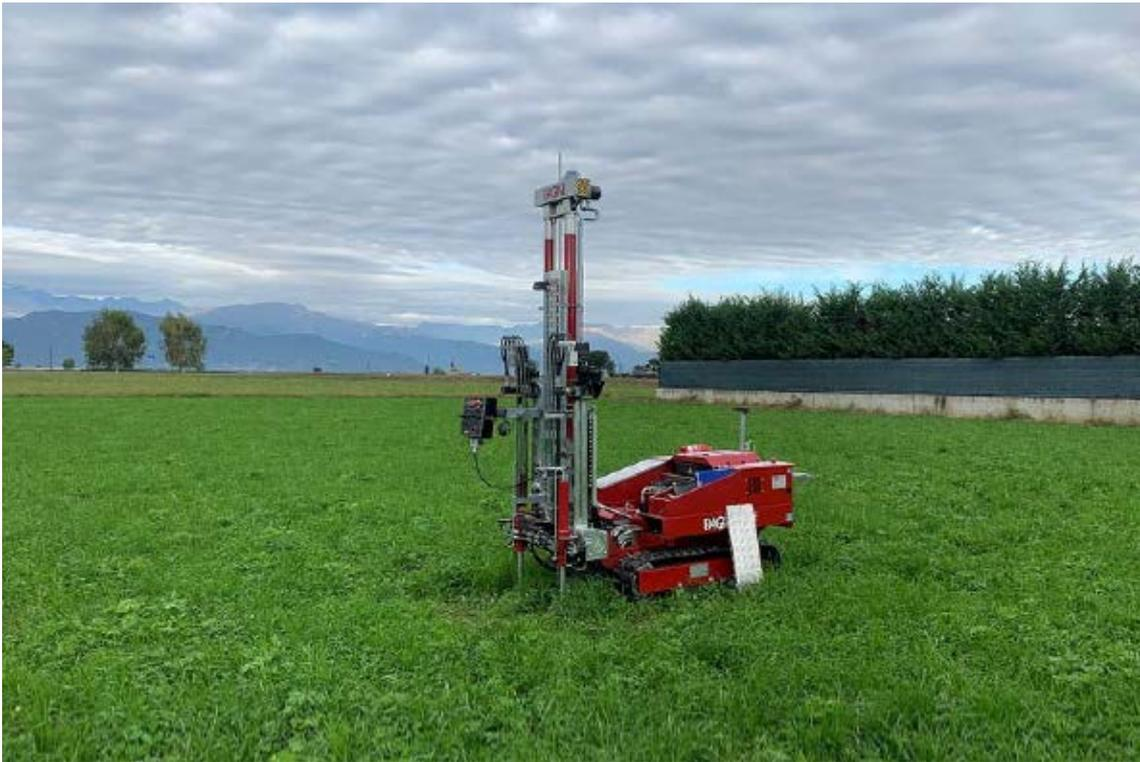
Foto 1. Esecuzione della prova penetrometrica dinamica P1
