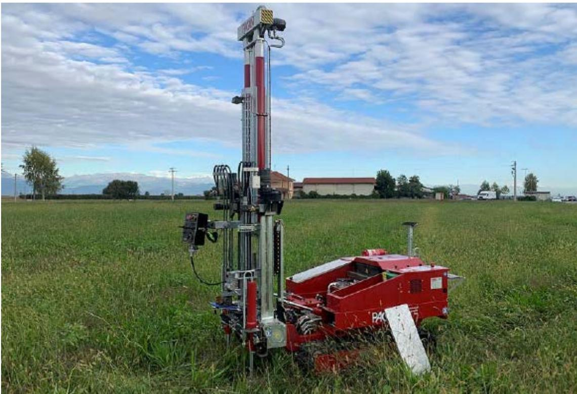
Foto 2. Esecuzione della prova penetrometrica dinamica P2
