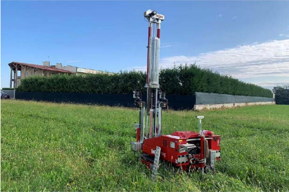
Foto 3. Esecuzione della prova penetrometrica dinamica P3
