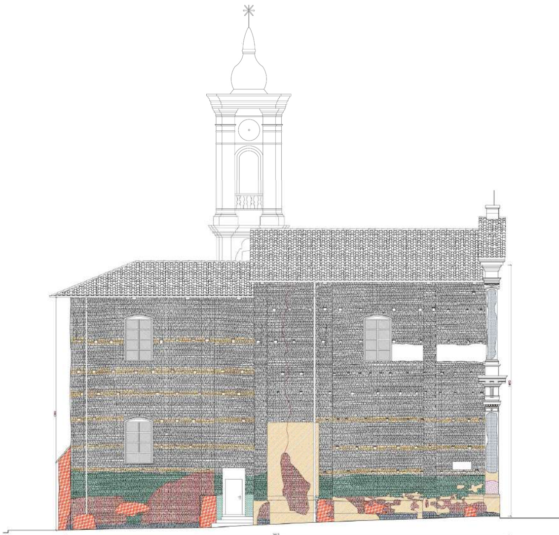
Analisi dei degradi - prospetto sud (tav. AD-12)
