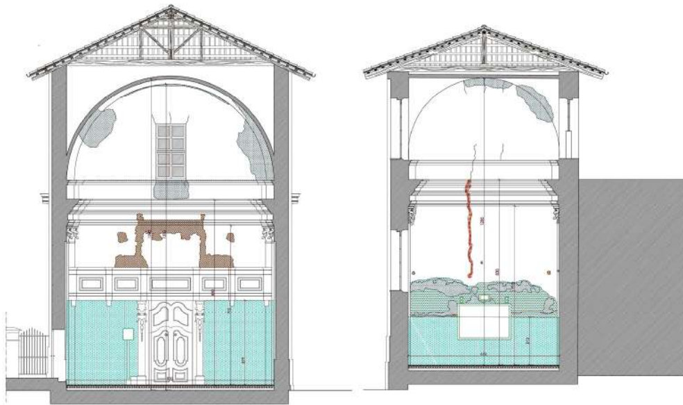
Analisi dei degradi – sezioni trasversali (tav. AD-14)
